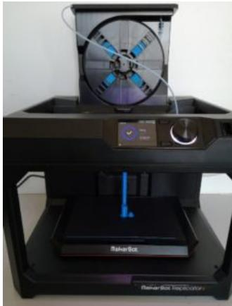
Das Gymnasium St. Xaver besitzt mehrere 3D-Drucker und einen 3D-Scanner. Diese Drucker besitzen eine beheizte Düse, welche in drei Richtungen bewegt werden kann. Motoren bewegen den Druckkopf über eine Arbeitsplatte, während die Düse Kunststoff durch Erhitzen verflüssigt und Punkt für Punkt auspresst. Dabei wird die Düse Lage um Lage nach oben bzw. die Arbeitsplatte lagenweise nach unten bewegt. Dadurch wird es möglich, dreidimensional zu drucken.
